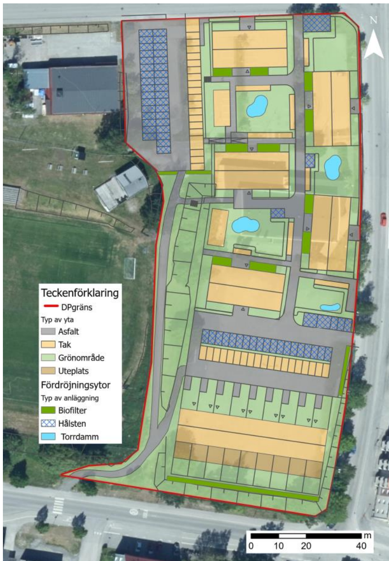
Figur 14 Förslag på placering av olika dagvattenanläggningar
