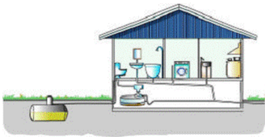
Figur 5. Urinsorterande toalett med biokammare och urintank (41).
